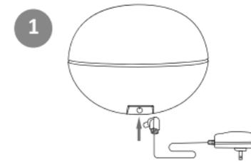
1. Conecte o plug da fonte de alimentação no conector.
